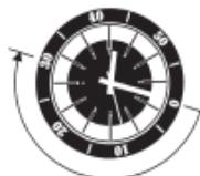
お客様の時計の外周に、分単位の回転式ダイヤルが備え付けられている場合は、様々な方法で経過時間の測定が可能です。例えば、30分間分のエアタンクでダイバーが潜水する場合、潜水開始時に三角形を分針に合わせるよう外側のリングを設定します。分針が示している外側リングの位置によってダイバーが何分間水中にいるのかが分かります。
