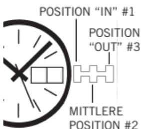
1. Die Krone in Position #3 ziehen und die Zeiger durch Drehen der Krone vorwärtsbewegen. Behalten Sie das Datum im Blick, während die Zeiger die 12-Uhr-Position durchschreiten. Datumsänderung erfolgt, wenn die Uhr Mitternacht anzeigt. Die Zeiger so einstellen, dass die korrekte Vormittags- oder Nachmittagszeit angezeigt wird. Die Krone wieder in Position #1 drücken.
