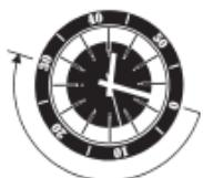
Se o seu relógio está equipado com um anel exterior rotativo com marcas de um minuto, poderá usar esta peça de várias formas para verificar o tempo decorrido. Por exemplo, se um mergulhador tem reserva de ar para 30 minutos, poderá ajustar o anel exterior, de forma a que, quando mergulha, o triângulo esteja alinhado com o ponteiro dos minutos. O ponteiro dos minutos indicará no anel exterior o tempo que o mergulhador está debaixo de água.
