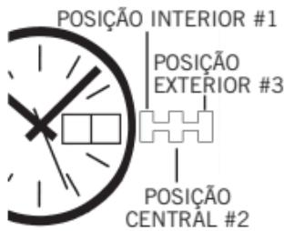
1. Coloque a coroa de ajuste para a posição no 3. Mova os ponteiros para frente girando a coroa. Observe a data quando os ponteiros passarem das 12 horas. Quando a data mudar é meia-noite no relógio. Ajuste os ponteiros para o horário correto A.M ou P.M. Empurre a coroa de volta para a posição no 1.
