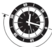
如果您的手表配有一个可旋转的外置分钟刻度表盘，这可以用于计算各种各样的方式的消耗时间。例如：如果潜水员有30分钟供气，当他下潜前可以设定表壳的外圆环，使圆环上三角型对准分针，然后分针指着在外圆环上的数字便是潜水员在水底的逗留时间。
