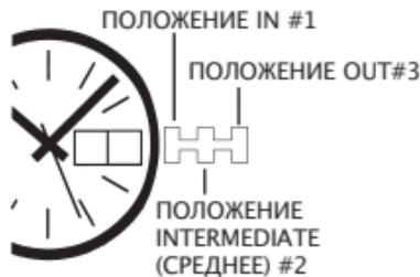
1. Вытяните заводную коронку в положение №3. Переведите стрелки часов вперед, вращая заводную коронку. Следите за изменением даты при прохождении стрелок отметки «12 часов». Если дата изменилась, то часы показывают полночь. Установите стрелки в положение, соответствующее текущему времени до или после полудня. Нажмите на заводную коронку, чтобы вернуть ее в положение №1.
