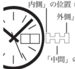
1. 設定竜頭を#3の位置に引き出します。竜頭を回して針を前方へ動かします。針が12時を過ぎるにつれて日付を注意して見ます。日付が変更するときには、時計上では真夜中です。針を設定して午前または午後の時間を修正します。竜頭を#1の位置に押し戻します。
