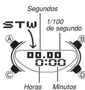
El modo de cronógrafo le permite medir el tiempo transcurrido, tiempo fraccionado y dos llegadas a meta.
