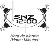
Se pueden ajustar tres alarmas diarias independientes. Cuando una alarma se encuentra activada, el tono de alarma suena cuando se alcanza la hora de alarma. Una de las alarmas es una alarma de despertador, mientras las otras dos son alarmas que suenan una sola vez. Se puede activar una señal horaria que ocasiona que el reloj emita dos zumbidos a cada hora sobre la hora de ajuste.
