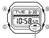
Indikator für automatischen Beleuchtungsschalter
