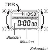
Der Countdown-Timer kann in einem Bereich von einer Minute bis zu 24 Stunden eingestellt werden. Ein Alarm ertönt, wenn der Countdown Null erreicht. Der Countdown-Timer weist auch eine Wiederholungsautomatik und einen akustischen Ablaufsignalgeber auf, der den Ablauf des Countdowns signalisiert.
