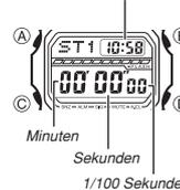
Die Uhr umfasst zwei Stoppuhr-Modi: Stoppuhr-Modus (ST1) und Stoppuhr-Modus (ST2). Beide Stoppuhr-Modi lassen Sie die abgelaufene Zeit, Zwischenzeiten und zwei Endzeiten messen. Der Stoppuhr-Modus (ST1) besitzt eine Auto-Start-Funktion.
