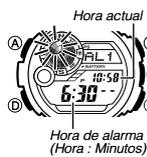
Puede ajustar cuatro alarmas sin repetición y una alarma con repetición. Al activarse una alarma, el reloj sonará durante aproximadamente 10 segundos cada día cuando la hora en el modo de indicación de la hora llegue a la hora de alarma preajustada. Esto tendrá lugar aunque el reloj no esté en el modo de indicación de la hora. También puede activar una señal horaria, la cual hará que el reloj emita dos tonos audibles a cada hora en punto.
