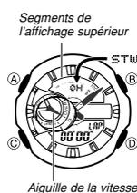
Le chronomètre permet de mesurer le temps écoulé, les temps de tours et les temps intermédiaires. Si vous spécifiez une distance, le chronomètre calculera et indiquera aussi des vitesses.
