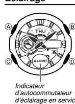
Une DEL (diode électroluminescente) éclaire l'afficheur de la montre pour qu'il soit mieux visible à l'obscurité. L'autocommutateur d'éclairage de la montre éclaire l'afficheur lorsque vous tournez la montre vers votre visage.
