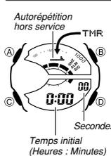
Le temps initial de la minuterie à compte à rebours peut être réglé d'une minute à 24 heures. Une alarme retentit lorsque le compte à rebours atteint zéro.
